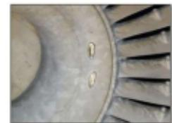
Устранение литевых дефектов в виде пор на поверхности колеса. Основа колеса выполнена из никелевых/титановых сплавов, наплавка – из того же материала
