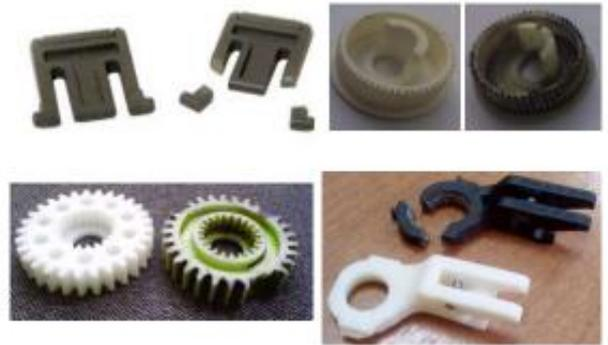
Восстановленная с помощью 3D-принтера и сломанная деталь из пластика
